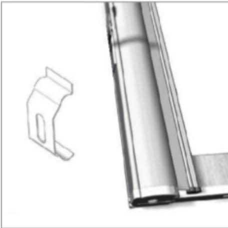
Befestigen der Kassetten durch Haltewinkel oder Clips
