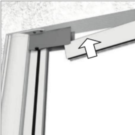
Führungsschiene in Nebentür-schnellmontagesystem einrasten
