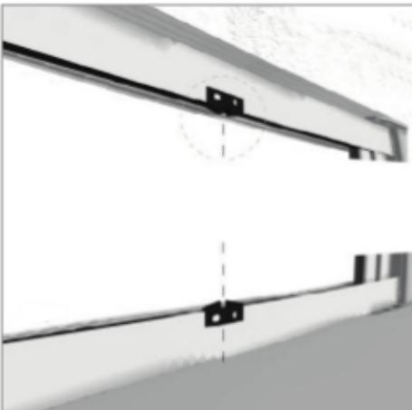
Überprüfen der Führungsfeststeller evtl. nachjustieren
