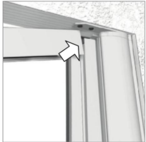
Führungsschiene an Haupttür aufstecken Gewindestifte befestigen
