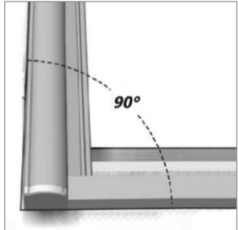
Überprüfen der Rechtwinkligkeit / Führungsschiene verschrauben oder Silikonkante etc.
