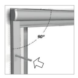
Position ermitteln / befestigen der Seitenschiene durch schrauben oder kleben
