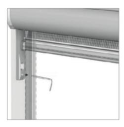
Gewindestifte in Seitenschiene befestigen
