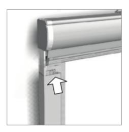
Kassetten auf Seitenschiene aufstecken Endanschlag muss zur Bedienseite zeigen
