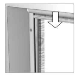
Griffschiene zur Bedienseite unten einrasten, zum Lösen in umgekehrter Reihenfolge Funktionskontrolle
