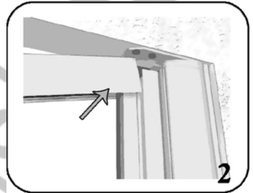
Wenn alles rechteckig ist wird die Führungsschiene verschraubt oder mit Silikon befestigt.
