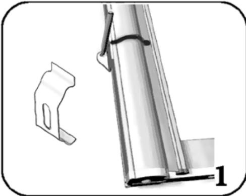
Im Anschluss die Führungsschiene in Nebentürschnellmontage einrasten.
